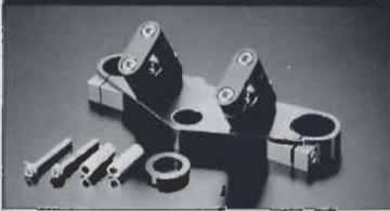
●RZ250R用オービック バーハンドル専用トップリッジKIT オフセットランプ付 カラー:ブロンズアルマイト仕上げ 32,000円
