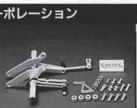
●RZ250R/RR用コースフィクスドレーシングステップ 55ミリバック+45ミリアップ 32,000円
