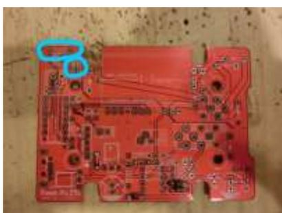
4) 次に実装するのはセラミックコンデンサです。使うセラミックコンデンサは頭が青色の部品です。
