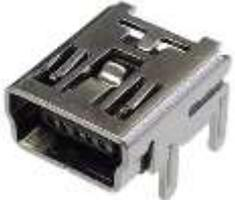
部品左端にシルク印刷通りに実装してください。配線以外の両端のガイドを先にハンダ付けすると固定されて端子側のハンダ付けはしやすいと思います。
